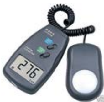
Luxómetros (instrumento para medir la intensidad lumínica).
