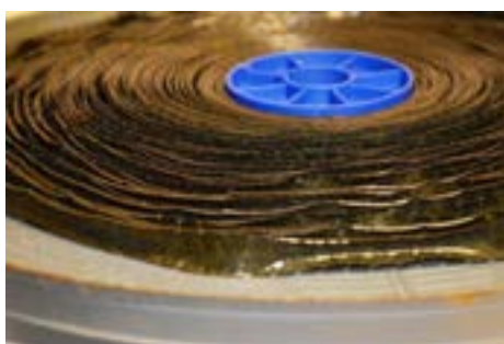
Película de acetato de celulosa afectada por el síndrome del vinagre. Fotografía: https://proyectoidis.org/sindrome-del-vinagre/ última consulta 3 de octubre de 2022
